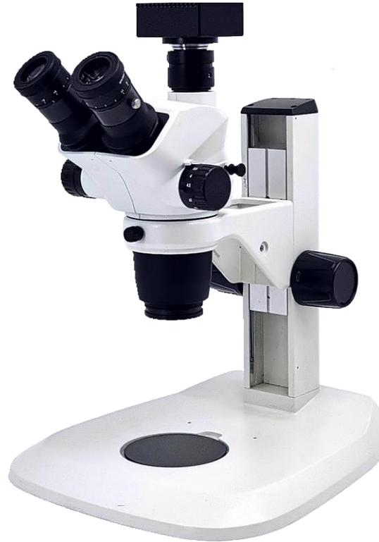
SC61 系列立體顯微鏡是採用高品質光學器件的緊湊型體視顯微鏡，搭載了光學性能優異的格里諾光學系統，同時實現了大範圍的變焦比和清晰的觀察影像。靈活運用了格里諾光學系統的特性，機體線條流暢而小巧。能在生產流水線發揮威力的同時，也最適合與設備組裝使用。最佳內向角的格里諾光學設計，V 字形光路使物鏡的尖端形狀能設計成細長形，使高度平直度和較深的焦點深度能同時實現。能從前面到內部正確對焦凹凸很大的樣品，得到充滿立體感的觀察圖像,影像平面彎曲的抑制，能更為逼真的觀察到樣品的形狀。
